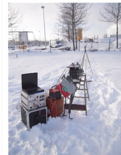
Gesamtansicht mit Laptop (oben), Steuereinheit der INN-Sonde (darunter), Stromversorgung (12V Batterie) und mechanischer Teufenanzeige der KAT (rot-weißer Kasten)
