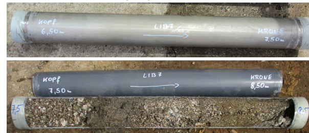
oben: Edelstahlliner für Laborversuch (gasdicht verschlossen) unten: HDPE-Liner (geöffnet für Phasenerkundung)
